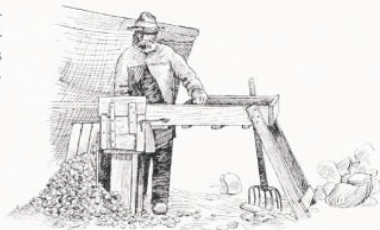
Fig. 67. Skærveslaaning i opret Arbejdsstilling. Maalestok 1:32.
